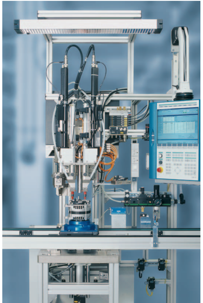
▲ Schraubstation zur Generatorenfertigung Tightening station for alternator production Station de vissage pour fabrication de générateurs Robert Bosch GmbH, Stuttgart, D
